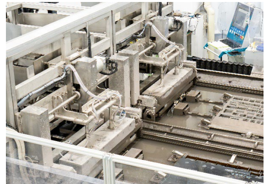
材料をウォータージェットが自動で切り出すライン (meviy デジタルマニュファクチャリングシステム)
